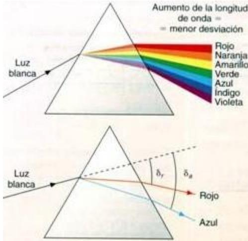
Sabemos que el índice de refracción de una sustancia disminuye con la longitud de onda incidente. Por tanto si un haz de luz de distintas longitudes de onda incide sobre un material refractante cada radiación se desviará con un ángulo diferente. A esto se le llama dispersión de la luz.
