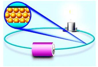
Según el tipo de material del conductor se producirá calor, el cobre es un buen conductor y produce poco calor, aleaciones de níquel y cromo producen conductores aceros que generan mucho calor al paso de la corriente.
