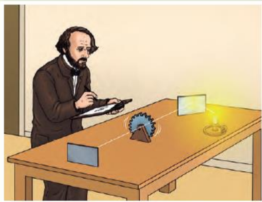
↑ Alrededor de 1850, el físico francés Armand Fizeau desarrolló un sistema de espejos y una rueda dentada para medir la rapidez de la luz. Su estimación fue de 3,1 \cdot 10^8 m/s.
